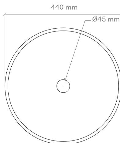
**POSITIONIERUNG VON ARMATUR UND AUFSATZBECKEN**
